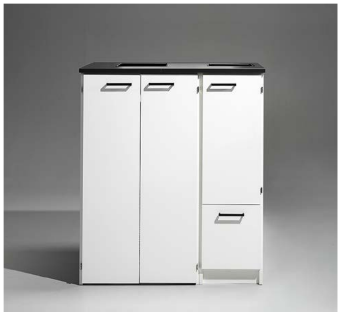
Miljöstation 4: Färdig modul enligt bild (970x1174x600 mm) med håltagning*. 250x250 mm i bänkskivan. Stationen är anpassad för 140 liters returkärl/wellvagn och 10, 19 och 60 liters kärl. Returkärl och wellvagn ingår ej. Rostfria handtag ingår som standard.
