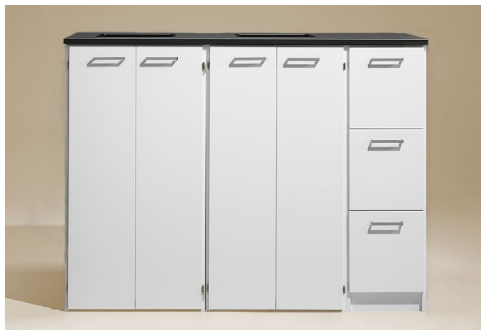
Miljöstation 2. Färdig modul (1670x1174x760 mm) med håltagningar. 350x350 mm i bänkskivan. Stationen är anpassad för 190 L returkärl/wellvagn och 19 + 10 L kärl. Returkärl, säckhållare och wellvagn ingår ej. Rostfria handtag ingår som standard.
